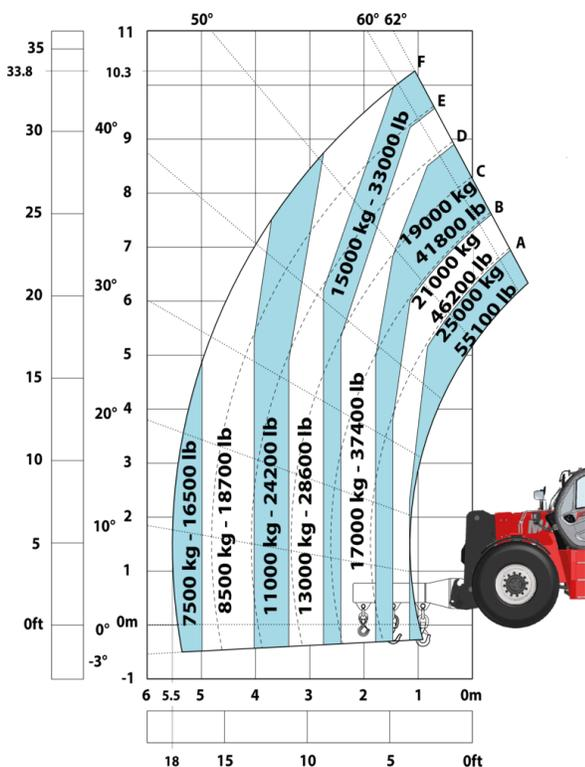
Машина на колесах с лебедкой 25000кг, метрическая система мер
